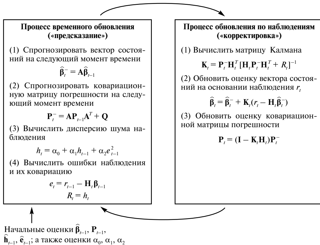
Рис. 3. Блок-схема алгоритма дискретного фильтра Калмана для получения оценок параметров модели (8)–(10)
